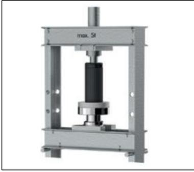
FT-P 與壓力機結合使用，可完美安裝內徑大於 50mm 的軸承，本工具可承受達 5 噸的安裝壓力。
