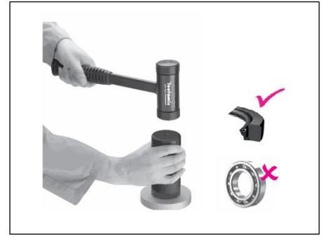
內徑小於 60mm 的密封圈可使用鋼沙防反彈錘輕鬆敲擊膠面安裝；內徑 55mm 的軸承必須使用 FT-P 結合壓力機安裝。
