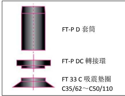
利用 FT-P 的 DC 轉接環去連接 FT 33 中適配 C 套筒的所有吸震墊圈，照樣可結合壓力機安裝。
